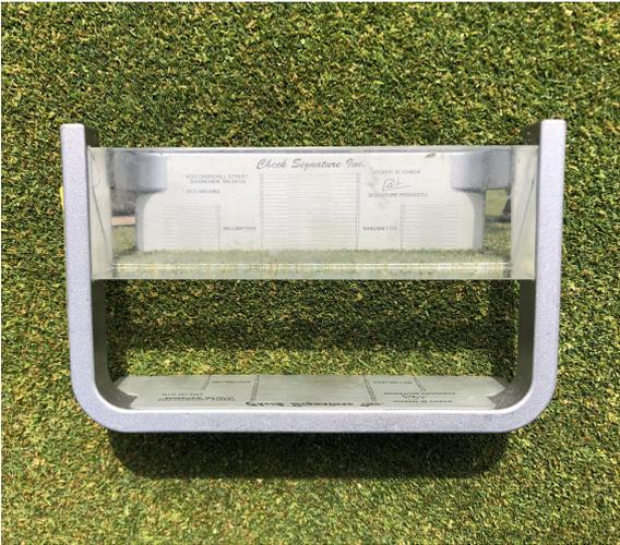
**Figura 7.4** - Prisma per la misurazione dell'altezza di taglio reale.
