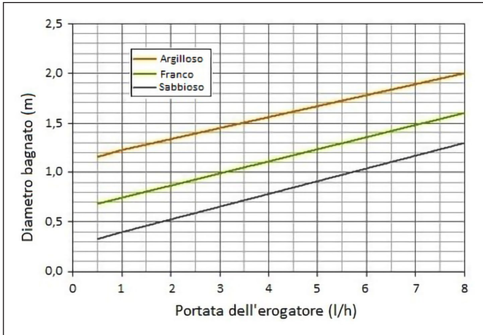
Figura 6.10 - Andamento del diametro dell'area bagnata in funzione del tipo di suolo e della portata dell'erogatore.
