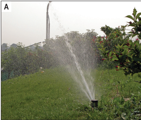
Figura 6.6 – Utilizzo irrazionale della vite rompigitto (a) che interviene eccessivamente a modificare l'omogeneità di distribuzione dell'acqua derivante da un bocaglio appositamente studiato. In (b) erogazione omogenea in assenza di vite rompigitto con adeguata pressione.
