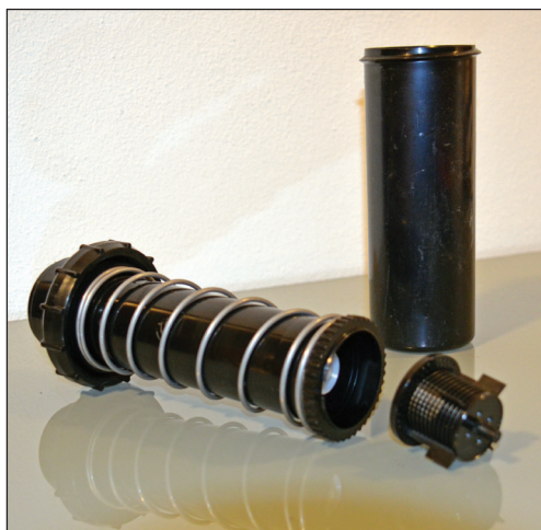
Figura 6.12 – Irrigatore pop-up a turbina con corpo separato dal guscio. È visibile la molla di richiamo indispensabile a far tornare in sede l'irrigatore al termine dell'irrigazione.
