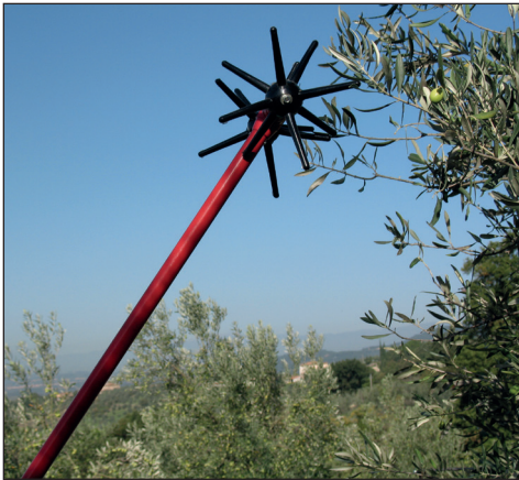
Figura 5.5 – Abbacchiatore con sfere stellate con movimento roto-vibratorio azionato elettricamente.
