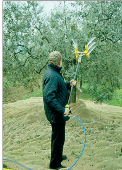
Figura 5.6 – Abbacchiatore pneumatico con bacchette rade e lunghe.
