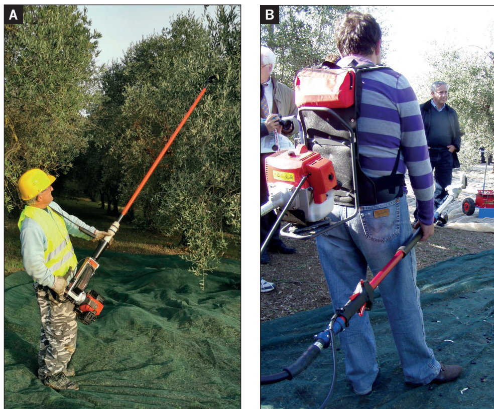
Figura 5.10 – Gancio scuotitore di branche azionato da motore endotermico (a) e motore zainato (b).
