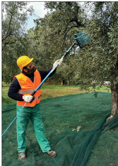
Figura 5.1 – Abbacchiatore con doppio pettine azionato pneumaticamente con aria compressa.
