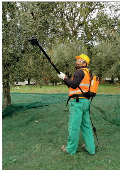
Figura 5.2 – Abbacchiatore elettrico azionato da batteria portata dall'operatore.
