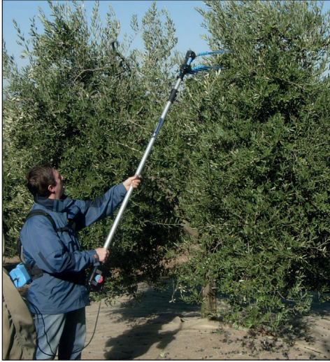
Figura 5.3 – Abbacchiatore elettrico con doppio pettine con movimento ellittico contrapposto azionato elettricamente da batteria portata dall'operatore.
