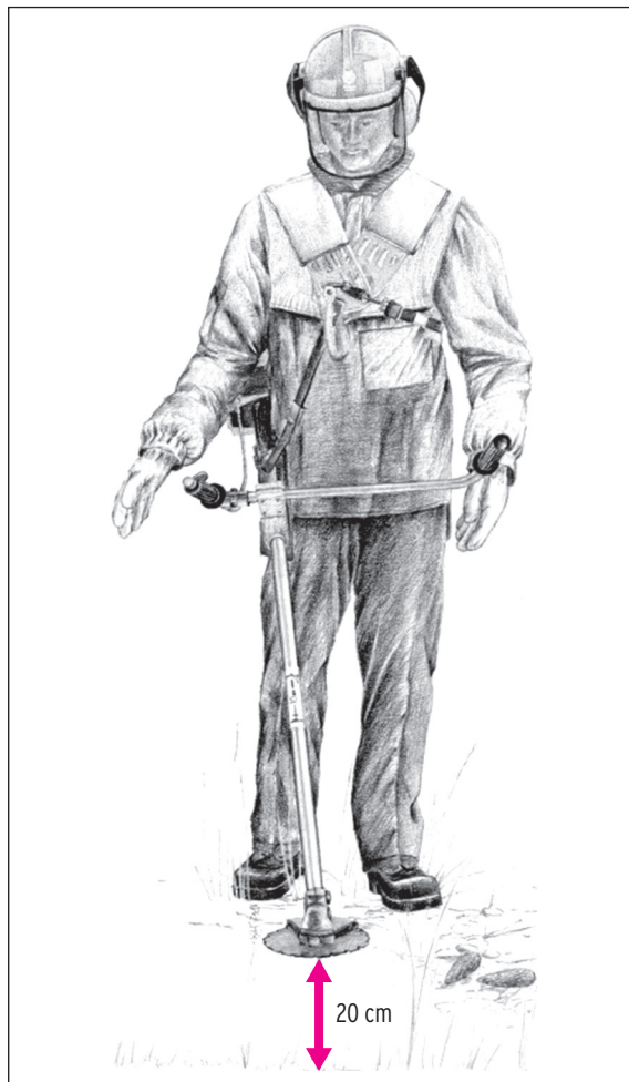
Fig. 1.6 | Corretta distanza di lavoro dell'organo di taglio dal terreno.
