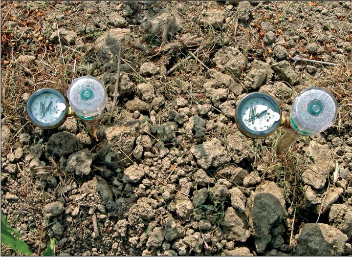
Figura 1.10 – *Monitoraggio delle condizioni di umidità del terreno a mezzo tensiometri.*
