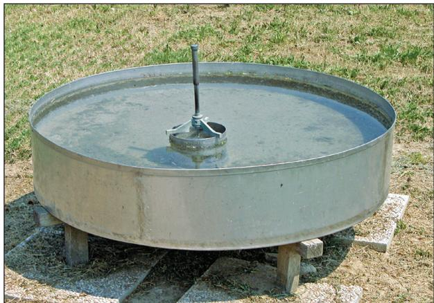
Figura 1.2 – Evaporimetro per la misurazione dell'evaporazione.
