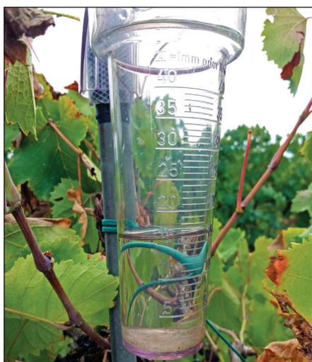
Figura 1.8 – Il pluviometro aziendale è uno strumento indispensabile per la verifica delle precipitazioni in ogni appezzamento.
