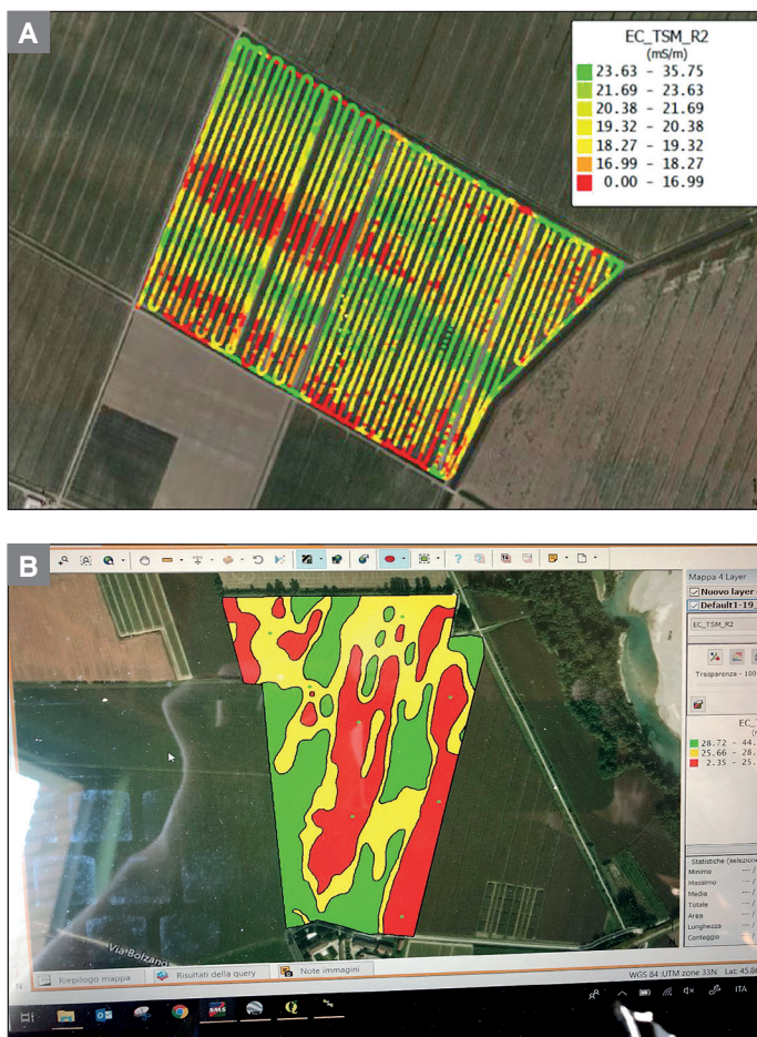
Fig. 5.13 | I passaggi col sensore geoelettrico per eseguire la misurazione su tutta la superficie del campo. La distanza di rilievo tra le linee è normalmente da 10 a 20 metri (A). In (B) elaborazione mappe di conducibilità. Tutti i dati rilevati sono poi elaborati con un apposito software per identificare le zone omogenee del campo e successivamente per eseguire rilievi in campo, al fine di definire le caratteristiche chiave di ogni singola area.
