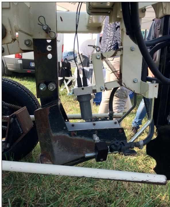
Fig. 5.11 | Un dettaglio del sistema di rilievo del pH del terreno. L'elettrodo esegue la misura del valore ad intervalli regolari per avere alla fine del rilievo una mappa dei punti di campionamento e valutare come varia il dato all'interno del campo.
