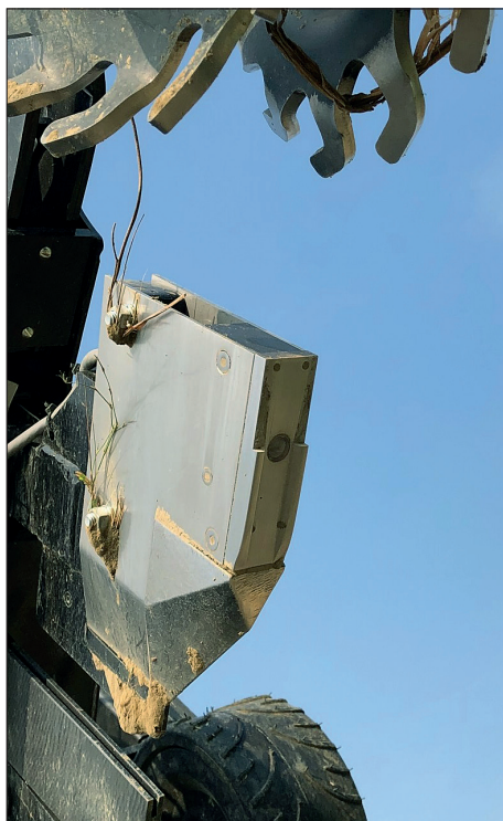
Fig. 5.8 | Particolare del lettore ottico Vis-Nir. Il sensore grazie a delle curve di taratura è in grado di determinare il valore di sostanza organica presente nel terreno indagato.
