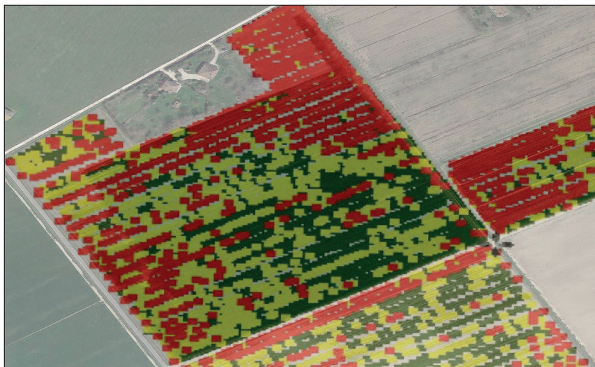
Fig. 5.14 | Una mappa di un rilievo eseguito con sensore Vir-Nir: in rosso le zone con valori bassi e in verde le zone con valori elevati di sostanza organica.
