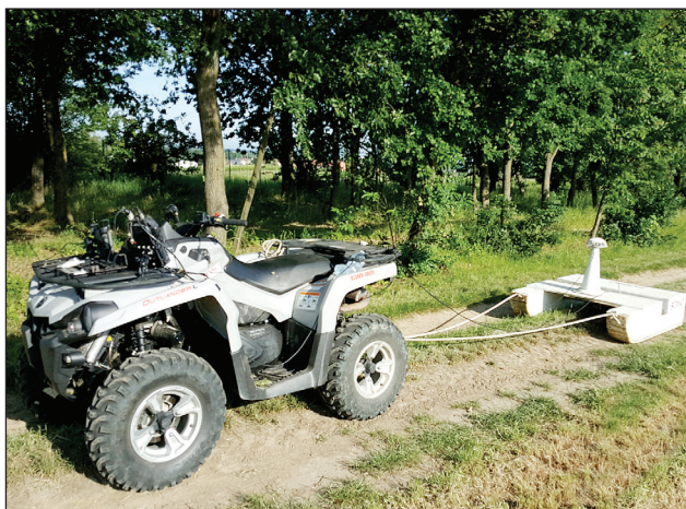
Fig. 5.6 | Sensore geoelettrico installato su una slitta trainata da apposito mezzo 4x4. Il sensore può essere installato sull'attacco a tre punti del trattore oppure su una slitta apposita che scivola sul terreno da mappare (Fonte AgriSoing).
