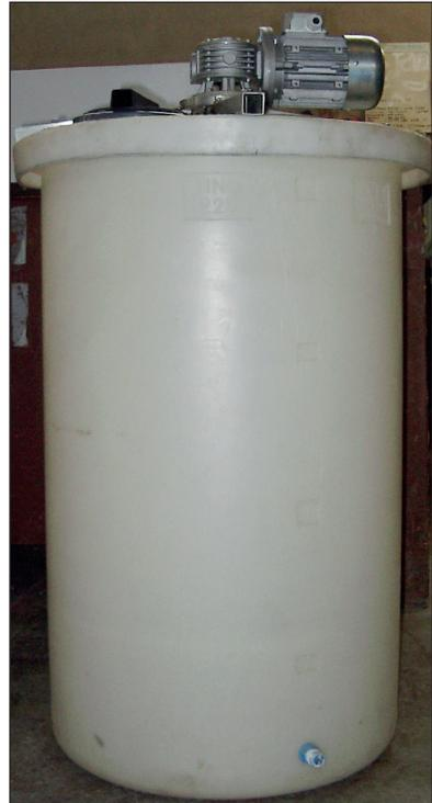
**Figura 2.2** | A destra serbatoio con elettroagitatore e sopra particolare dell'agitatore all'interno dei serbatoi dei fertilizzanti.
