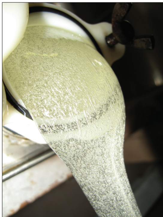
Figura 1.10 – Il miele esce dal rubinetto della centrifuga. Si noti l’elevata presenza di bolle di aria inglobate durante la centrifugazione (Foto Donetti Sarah).
