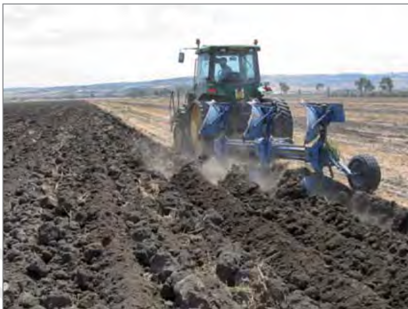
Fig. 1.5 - Aratura con polivomere reversibile (da Pisante, 2007).
