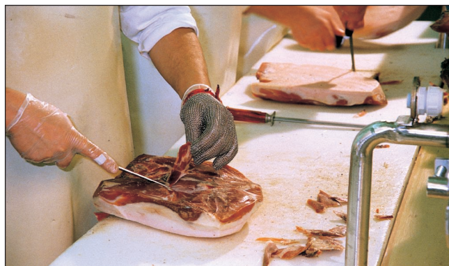
Figura 3.2 – Esempio di operazioni con coltello: l'operatore ha la mano sinistra protetta da un guanto di maglia d'acciaio.
