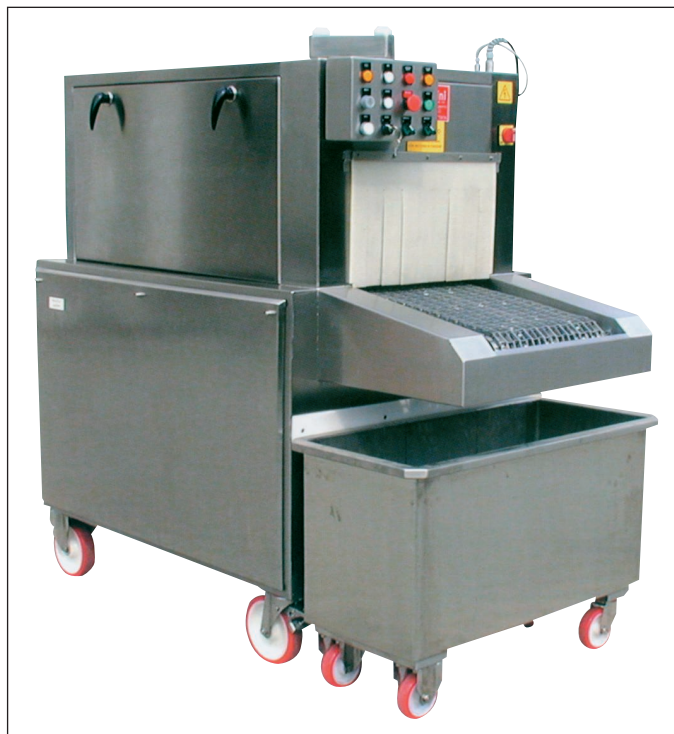
Figura 3.5 – Dissalatrice ad aria forzata. Il sale viene recuperato nella vasca visibile frontalmente (Ditta Soncini Alberto S.p.A.).
