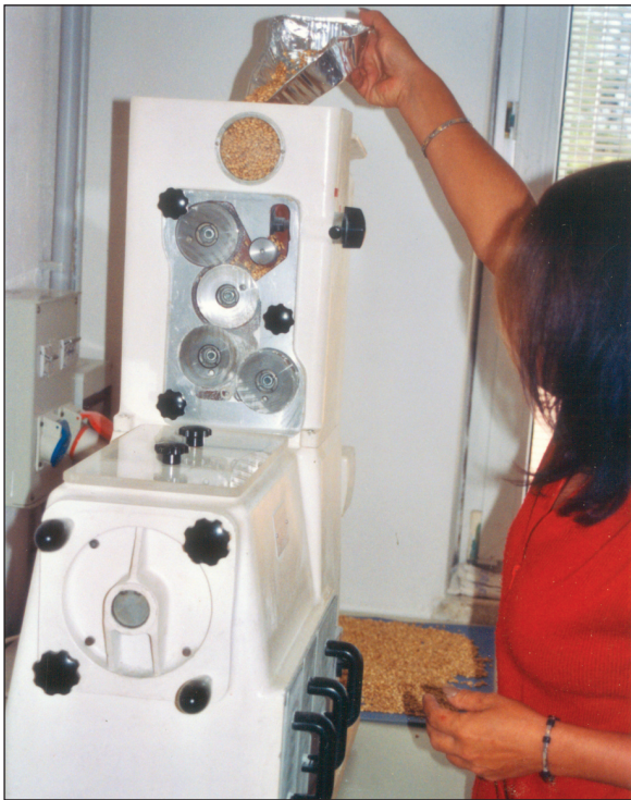
Fig. 1.3 | Molino da laboratorio usato per ricavare le farine sperimentali dalle vecchie varietà di frumento tenero.
